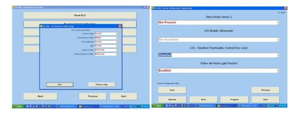
Следующее полезное окно позволяет активировать функцию закрытия окон с брелка (Comfort Closing). В следующим окне можно активировать Seatbelt Reminder "Напоминание непристегнутого ремня безопасности" и Welcome Light "Вежливый свет" (при открытии двери водителя загорается подсветка приборной панели и приемника).
