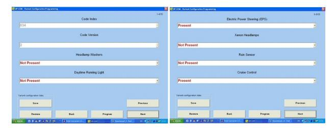
Но для проверки заходим в окно двигателя, в режим программирования и выставляем в графе "Cruise Control" - "Present" и жмем кнопку "Perform Coding". Продолжаем дальше рассматривать модуль управления кузова. В этом окне можно активировать функцию Follow Me Home Light Function "Дорога домой".
