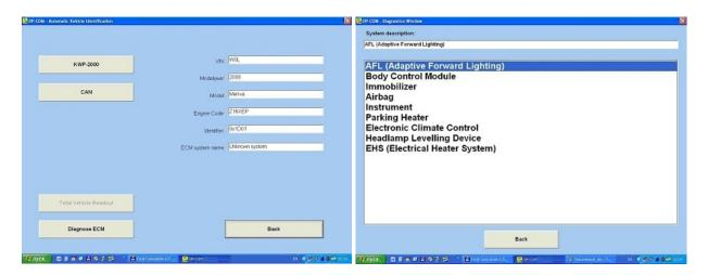
В этом окне, как и во всех других подобных возможно просмотреть имеющиеся ошибки (Fault Codes), просмотреть параметры модуля (Measuring Blocks), выполнить тесты исполнительных механизмов (блоков) модуля (Output Tests) и изменить его конфигурацию (Programming). Нам необходимо изменить конфигурацию модуля, поэтому затем жмем кнопку "Programming". Открывается окно Programming Function где выбираем Programm Variant Configuration
