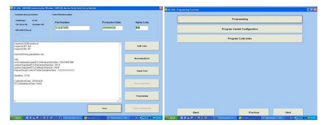
Произойдет запрос секретного кода. Он берется из CarPass автомобиля - четырехзначное число. Некоторое время происходит считывание данных их модуля. Затем открывается окно, где возможно изменение конфигурации оборудования. Цифры в правом верхнем
